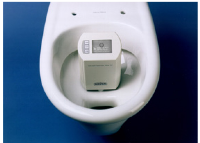
Abb. 5: Der kompakte Krüss Top Drop Analyser TDA10 bei der Messung der Benetzbarkeit eines Sanitär Objektes.
