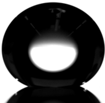
Abb. 1: Wassertropfen auf einem ultrahydrophoben Coating
